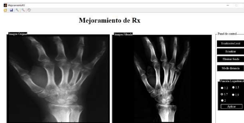
Figura 2. Interfaz gráfica para mejoramiento de imágenes por medio de ecualización en MATLAB. Fuente: Elaboración propia.
