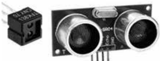
Figura 4. Sensores CNY70 y HC-SRC04
