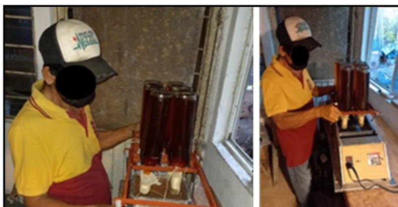
Figura 5. En la imagen se muestra el prototipo de encerado procesando seis botellas por ciclo. Fuente: Autoría propia.
