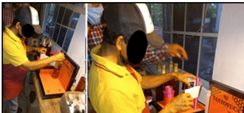
Figura 6. En la imagen se muestra el prototipo de etiquetadora procesando seis botellas por ciclo. Fuente: Autoría propia.
