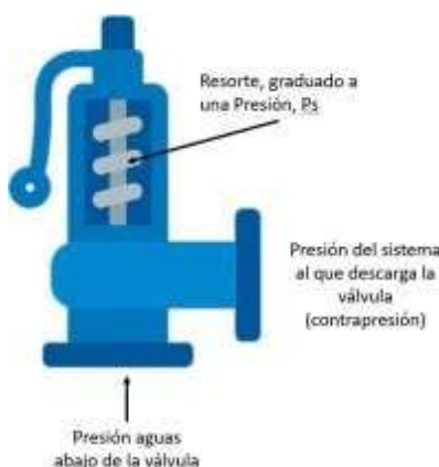
Figura 1. Válvula de Seguridad operada por resorte
