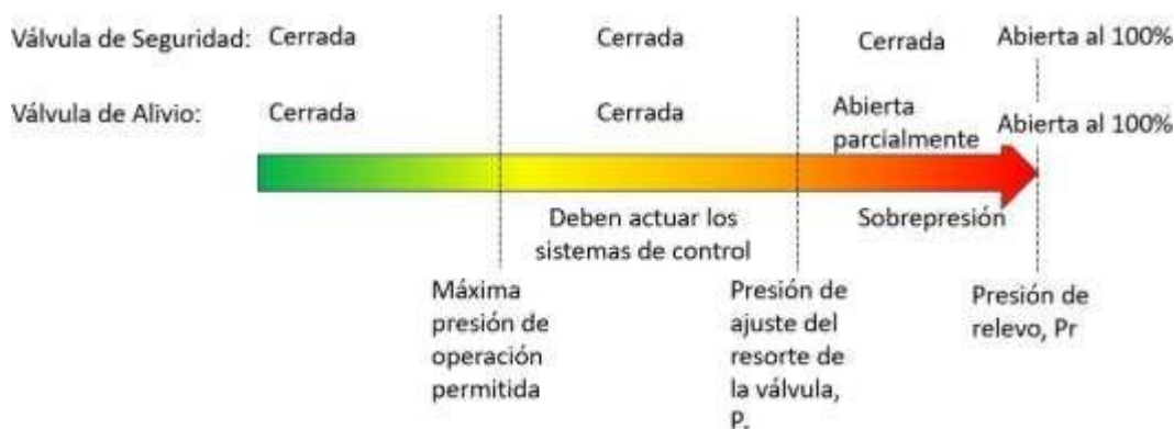
Figura 2. Presión interna del recipiente protegido vs. respuesta de la válvula.
