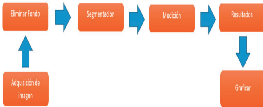
Figura 1. Diagrama de bloques del proceso de la detección de polímeros.
