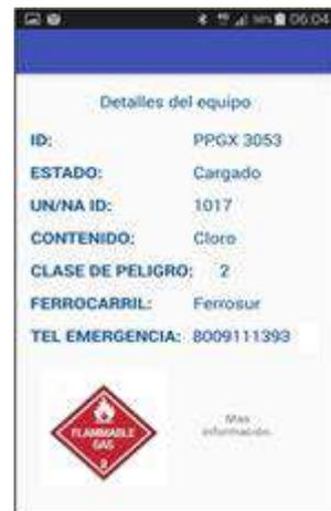
**Figura 3.** Pantalla que muestra los detalles del equipo en cuanto a contenido, tipo de riesgo y teléfono de emergencia del ferrocarril propietario.
