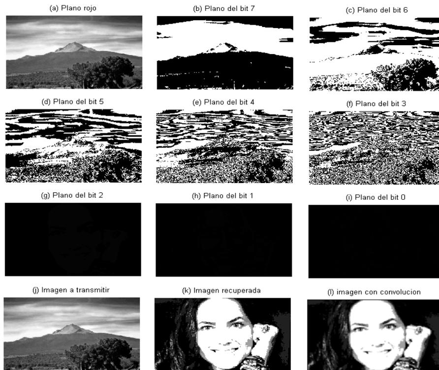
**Figura 3.** Planos de bit para el plano Rojo e imagen transmitida y recuperada.
