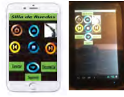
Figura 4. Interfaz de comunicación que permite al usuario establecer un enlace de comunicación entre el dispositivo móvil y los brazos robóticos de la silla de ruedas.
