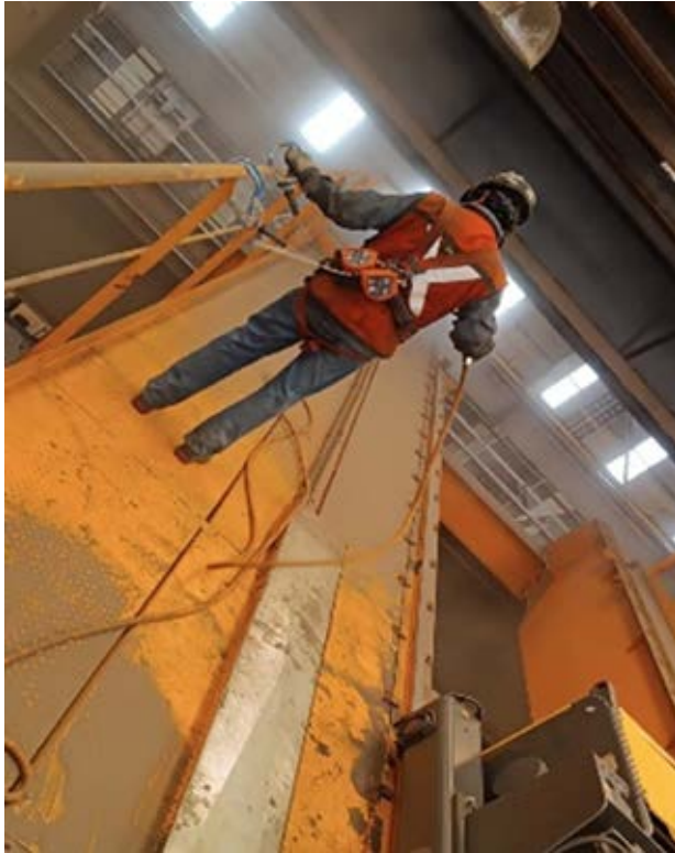
Fuente: Empresa fabricante de carros de ferrocarril Imagen 13: Realizando la limpieza con aire comprimido
